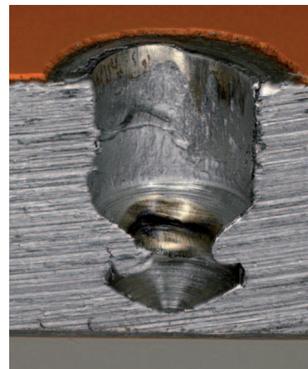
Základní ocel po sedmi letech působení mořské vody a vytažení hřebce X-BT. Otvor vypadá čistý a nejsou viditelné žádné známky koroze.
