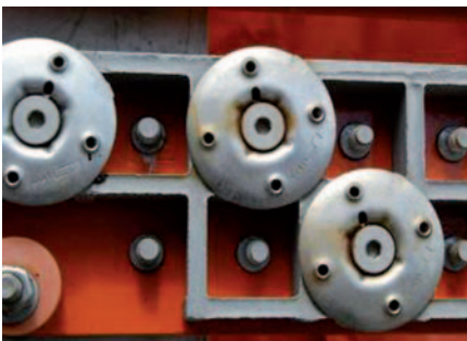
Stojan pro zkoušky v mořské vodě s osazenými vzorky (hřeby X-BT bez talířů X-FCM).
