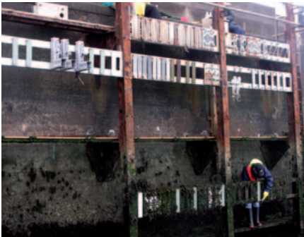
Stojan pro zkoušky v mořské vodě s osazenými vzorky (hřeby X-BT bez talířů X-FCM).
