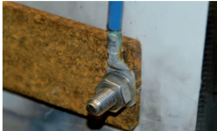
Uspořádání zkoušky hřebu X-BT s kabelovým okem
