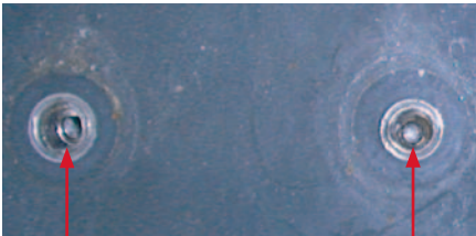
Vyvrtné otvory po 90denním testu solnou mlhou a po vytažení závitových hřebů X-BT. Otvory vypadají čisté a nejsou viditelné žádné známky koroze.
