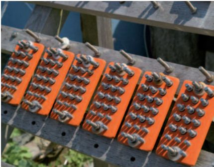
Stojan pro zkoušky v mořské atmosféře s osazenými vzorky hřebů X-BT.
