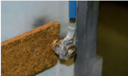
Uspořádání zkoušky hřebu X-BT se dvěma maticemi
